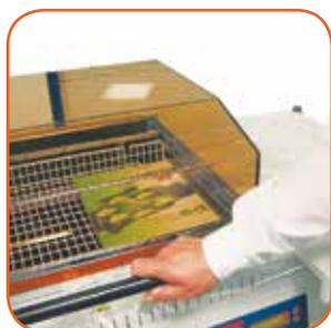
La fermeture de la cloche déclenche simultanément la soudure coupe en «L» et la chauffe instantanée dans la cloche pour la rétraction du film.
