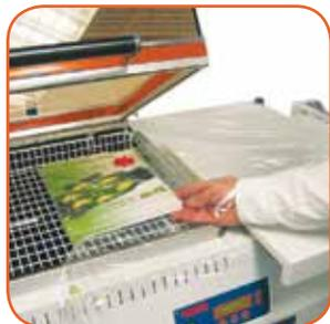
Le produit est introduit à l'intérieur de la poche formée par le film dossé. L'opérateur positionne le produit dans le cadre de soudure en « L » à l'intérieur de la cloche.
