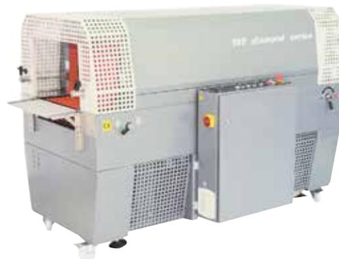
Ces fardeleuses automatiques pouvant atteindre des cadences de 20 coups minute intègrent un tunnel de rétraction à double voie. Elles sont disponibles en 3 largeurs de barre de soudure (680 - 840 - 1050 mm) avec une hauteur de passage de 250 mm en standard. 2 types d'alimentations en ligne par convoyeur ou à 90°.
