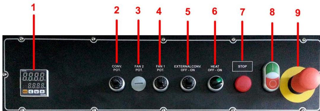
Le panneau de commande de la machine est composé des éléments suivants :
