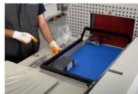
La barre de soudure se fermera pendant la période prédéterminée comme expliqué ci-dessus dans la section des configurations.
