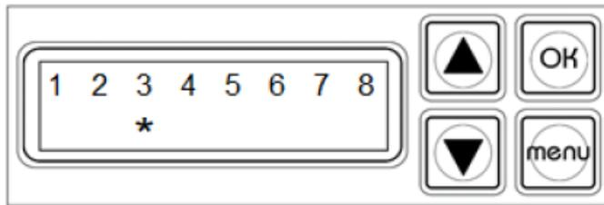
Il s'agit du détecteur de proximité situé au niveau de la barre de soudure. L'étoile apparaît toujours et ne disparaît que pendant la période de soudure.
