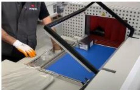
Une fois la soudure terminée, la barre s'ouvrira à nouveau et le tapis roulant motorisé commencera à fonctionner.
