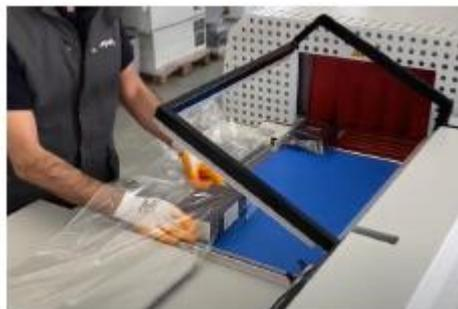
Laissez l'excédent tomber dans le bac à chutes, à moins que votre machine ne soit équipée d'une application d'enroulement de chutes en option.
