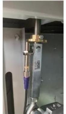
**Capteur 4 : Capteur de sécurité de la barre de soudure**
