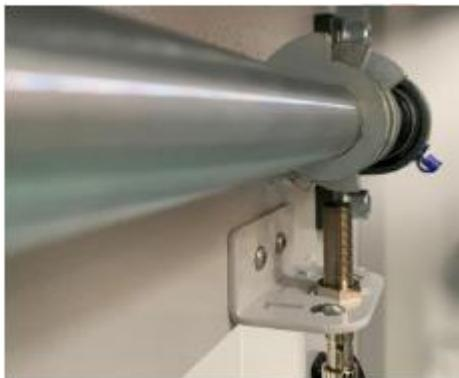
Le niveau 2 est l'ouverture par défaut de la barre de soudure. Si ce niveau n'est pas suffisant pour votre application, veuillez déplacer le capteur au niveau supérieur suivant.
