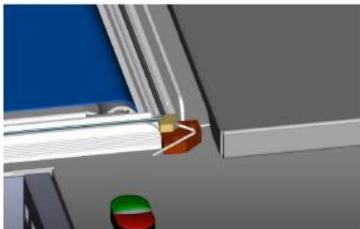
Le matériau isolant du coin maintient fermement le coin du fil. Alors, desserrez d'abord les vis et assurez-vous que le fil sort de son lit de fibres.
