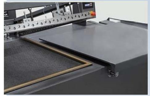
Les soudeuses en « L » **LMC-P** sont disponibles en trois tailles de cadre de soudure. Elles sont conçues pour des produits longs et peuvent être intégrées à tous types de tunnel. Le mode de fonctionnement est simple, le produit est introduit entre les deux faces du film dossé et il est poussé par l'opérateur dans le cadre de soudure. Le bras de soudure descend et fait une soudure/coupe en forme de « L ». Dès la remontée du bras, le convoyeur évacue le produit.
